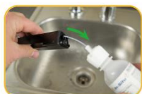
在缓慢拔出填充管的同时，将填充液滴入储液器中，直到滴满溢出
