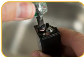
重新安装拧紧参比端子
