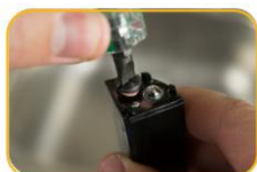
从仪器上拆下传感器，拧开参比端子
