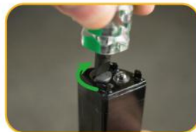
再转动90度(四分之一圈)以固定参比端子
