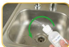
轻轻摇动装有参比液的瓶子，并倒置混合
